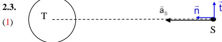
2.4. Le satellite ayant un mouvement circulaire et uniforme, alors  $\vec{a}_S = \frac{v_S^2}{(R_T + h)} \cdot \vec{n}$
